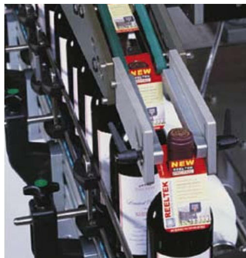
Ein Engpass weniger: die Flaschenanhänger-Maschine beschleunigt die Fertigstellung
